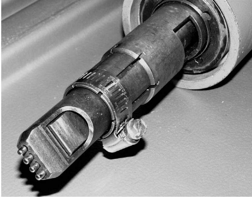
Figure 6.15 UIT Treatment Tool Head
