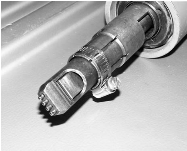
Figure 10.4 View of Pins on UIT Tool Head
