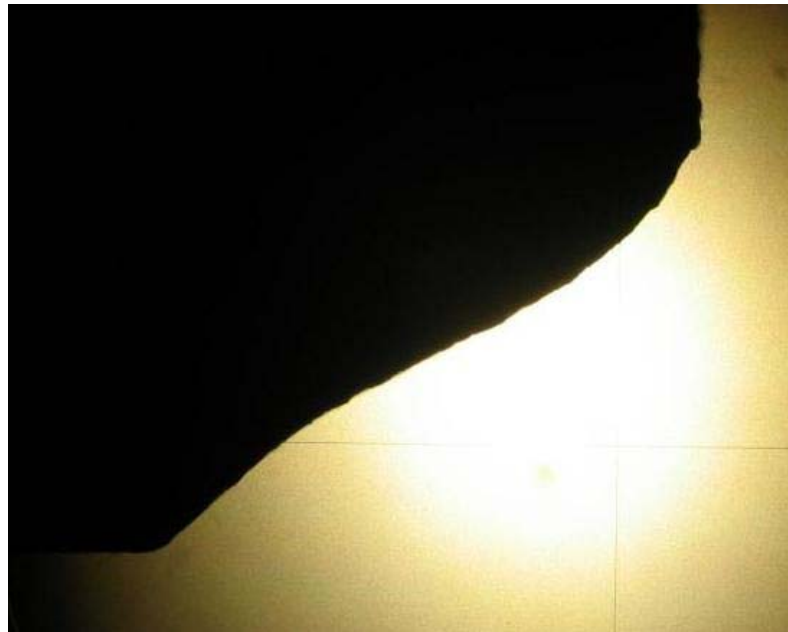
Figure 8.5.3.3 10x Magnification of Mast Arm Weld DU Before UIT
